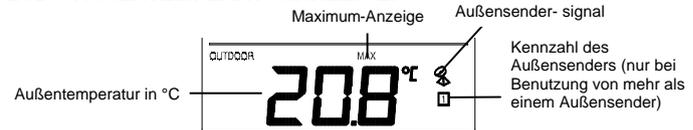
Der vierte Gruppe auf dem LCD-Bildschirm zeigt die Außentemperatur und ein Sendersignal an. Wenn mehr als ein Außensender benutzt wird, wird unten rechts die Kennzahl des aktuell angezeigten Senders ebenfalls angezeigt.
