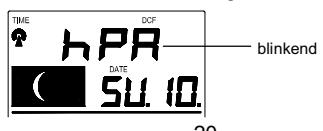
Die Luftdruckanzeige kann so eingestellt werden, dass der Relative Luftdruck in hPa oder inHg ausgegeben wird (Voreinstellung hPa).
