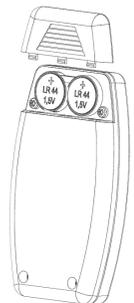
Bei zwei Bedienungen je Tag beträgt die Lebensdauer neuer Batterien ca. 4 Jahre. Ein Batteriesymbol (🔋) im Display weist darauf hin, dass die Batterien auszutauschen sind.
