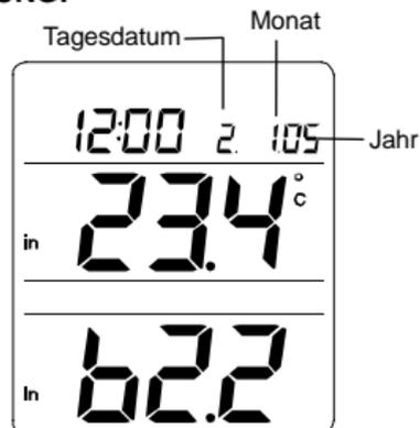
Die Kalendervoreinstellung der Wetterstation ist der 1.1. des Jahres 2004. Wird das funkgesteuerte DCF-Zeitsignal empfangen, wird damit automatisch auch das Kalenderdatum auf den neuesten Stand gebracht. Ist kein DCF-Signalempfang möglich, so kann das Datum auf folgende Weise auch manuell eingestellt werden:
