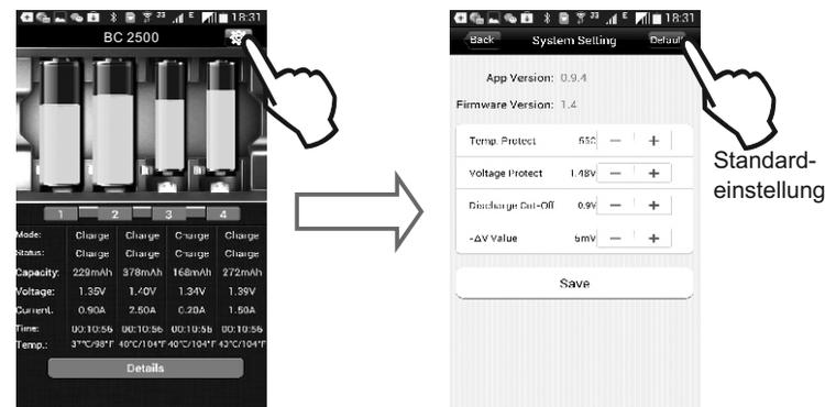
Drücken Sie das „Details“-Taste um die Spannungsgrafik und den Akku-Innenwiderstand anzuzeigen. Wählen Sie den jeweiligen Akku aus, indem Sie ihn auf dem Display berühren.
