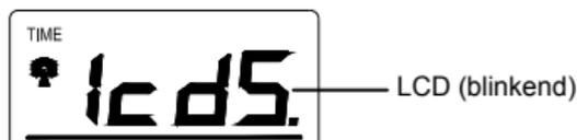
Der LCD-Kontrast kann entsprechend dem Wunsch des Anwenders in 8 verschiedenen Stufen eingestellt werden (Voreinstellung LCD 5). Einstellung der Kontraststufen wie folgt:
