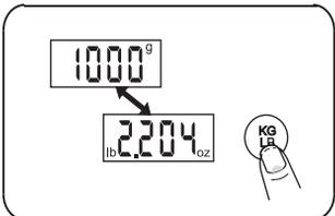
Drücken Sie während des Wiegens die KG/LB Taste, um zwischen der metrischen und imperialen Einheit zu wechseln.
