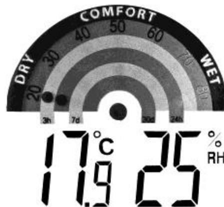
Nach Inbetriebnahme des Gerätes dauert es entsprechend dem Intervall, bis ein durchschnittlicher Feuchtwert vorliegt, solange wird der Punkt auf der Skala bei 50% langsam blinkend dargestellt, bzw. wird in der App "---" gezeigt.
